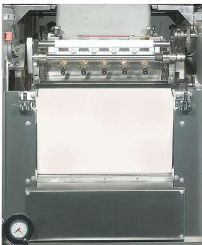
Gruppo pistoni dosatori di facile accesso e pulizia. Volantino esterno per una facile regolazione della tensione del telo di arrotondamento (anche durante il funzionamento). Tramoggia in acciaio inox teflonata con capacità di 55 kg. Sfarinatore mobile di serie.
