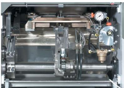
Dispositivo di aspirazione e compressione pasta con regolazione idraulica (anche durante il funzionamento della macchina). Questo dispositivo permette di lavorare delicatamente la pasta secondo il tipo d'impasto.
