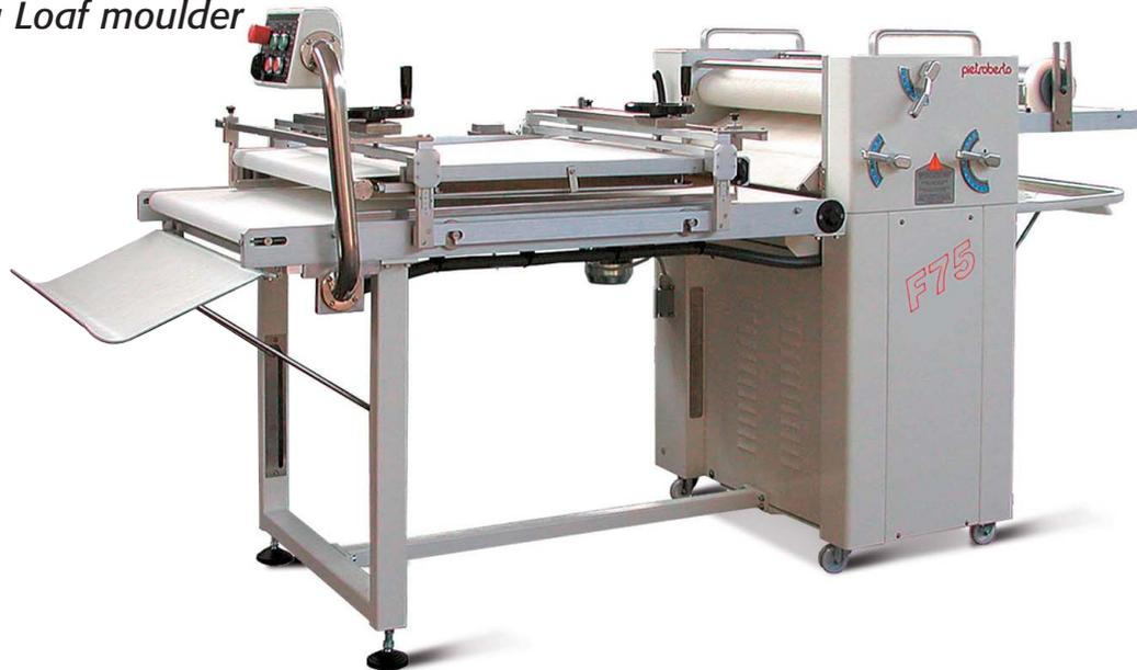
Macchina versatile e di pratico uso che, grazie ai suoi 4 cilindri laminatori, permette la formatura di qualsiasi tipo di pasta e di vari formati senza maltrattamenti. Il formato risulta così, ben avvolto e privo di bolle d'aria.
